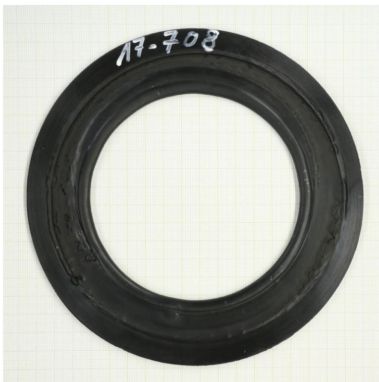
Creep relaxation test at 40 MPa – 85 °C (EN 13555)
