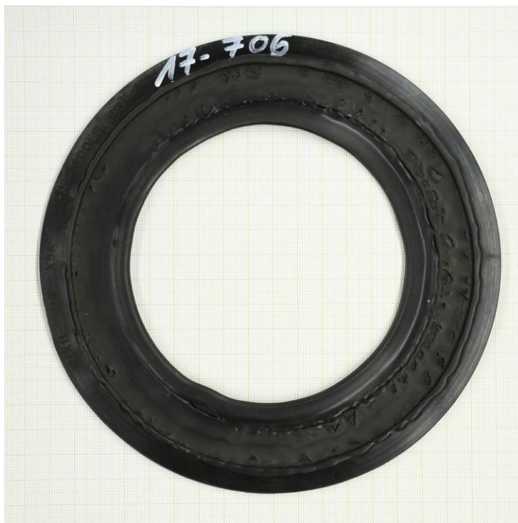
Creep relaxation test at 40 MPa - 100 °C (EN 13555)
